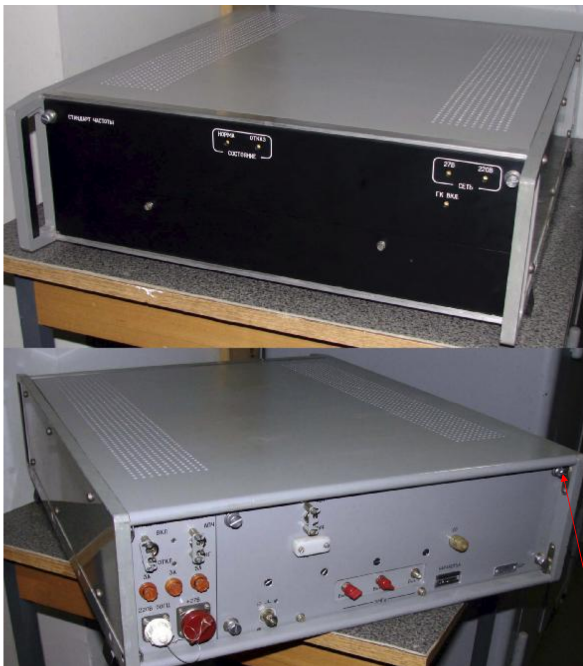
Рисунок 4 – Внешний вид стандарта частоты ТСЮИ.433741.007
