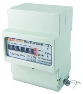
Конструктивно счетчики выполнены в виде моноблока из пластика, на лицевой панели которого размещены отсчетное устройство и клеммная колодка, закрываемая крышкой. На тыльной стороне корпуса расположены направляющие (отверстия) для крепления счетчика на месте установки.
