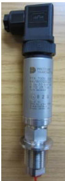
Рисунок 1 – Внешний вид преобразователя РТХ 7000
