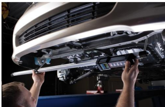
Общий вид устройств для измерений координат контрольных точек кузова автомобиля IntelliTape
