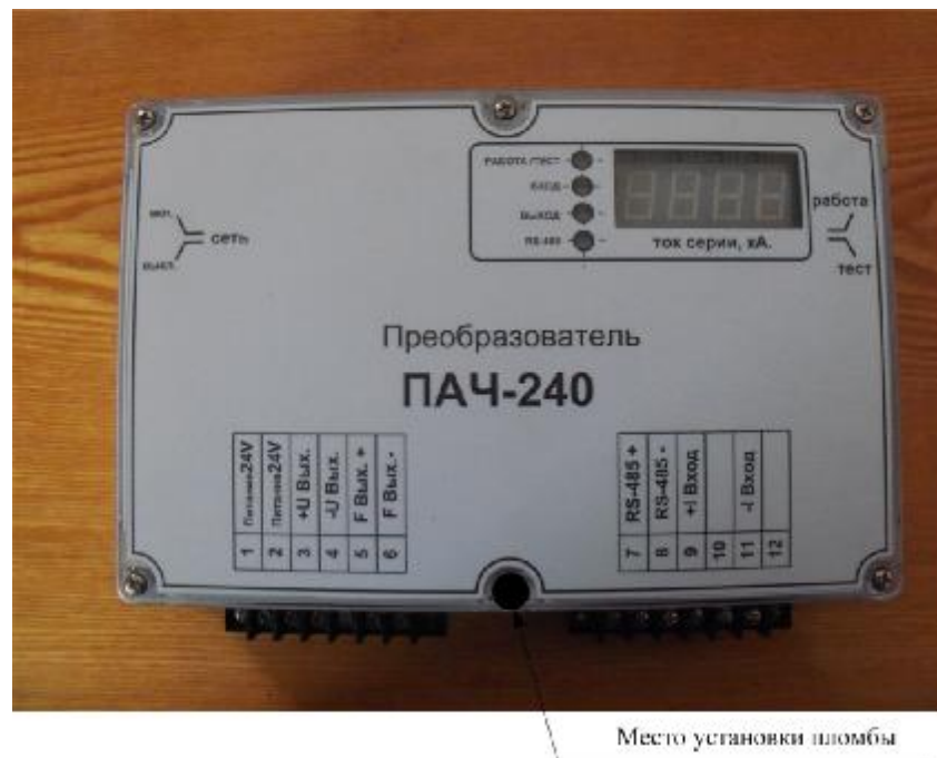
Рисунок 1. Внешний вид преобразователя и места пломбирования корпуса
