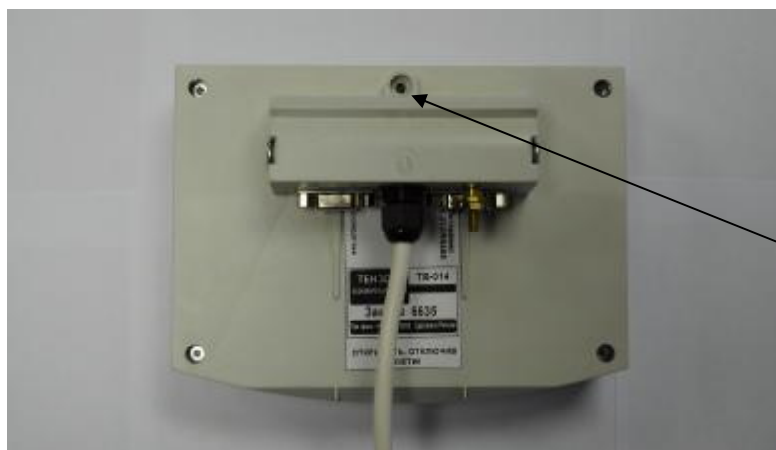
Рисунок 7 – Место пломбировки от несанкционированного доступа на преобразователе ТВ-014.
