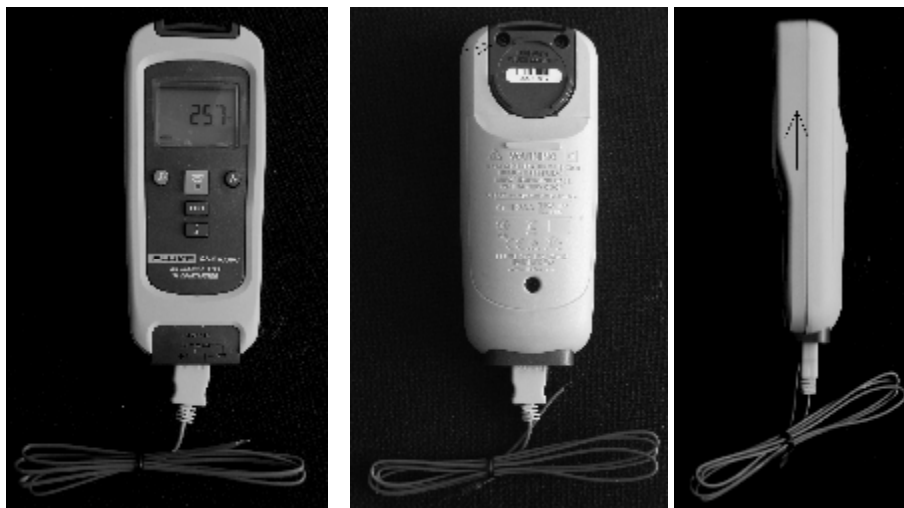
Рисунок 1 - Внешний вид измерителя температуры с функцией дистанционной передачи данных Fluke CNX t3000.
