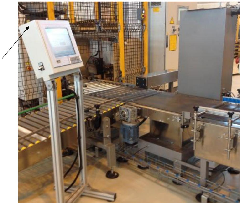
Рис. 1 Внешний вид весов автоматического действия AC1-150-NF
