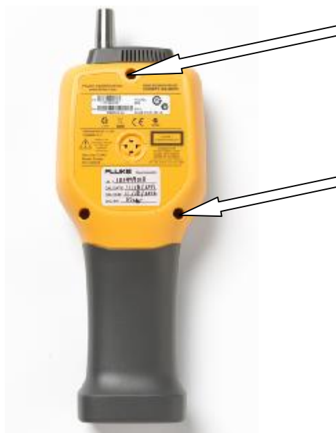
Рисунок 2 – Схема пломбировки счетчика частиц от несанкционированного доступа
