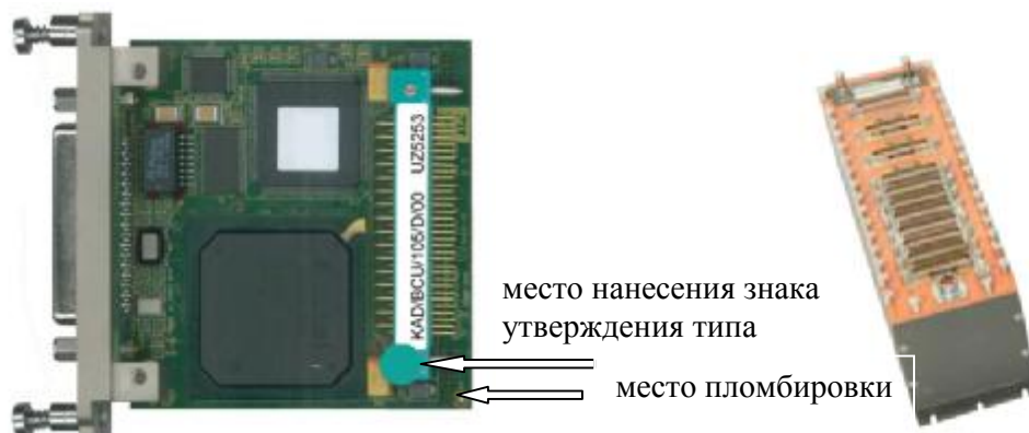
Рисунок 1 - Внешний вид модуля KAD/BCU/105 и модуля KAD/BCU/105 установленного в блок базовый КАМ/СНС/13U
