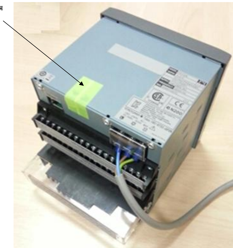
Рисунок 2 – Схема пломбирования наклейкой регистратора
