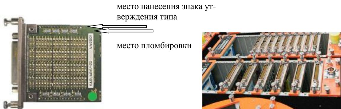
Рисунок 1 - Внешний вид модуля KAD/ADC/120 и модуля KAD/ADC/120 установленного в блок базовый КАМ/СНС/13U
