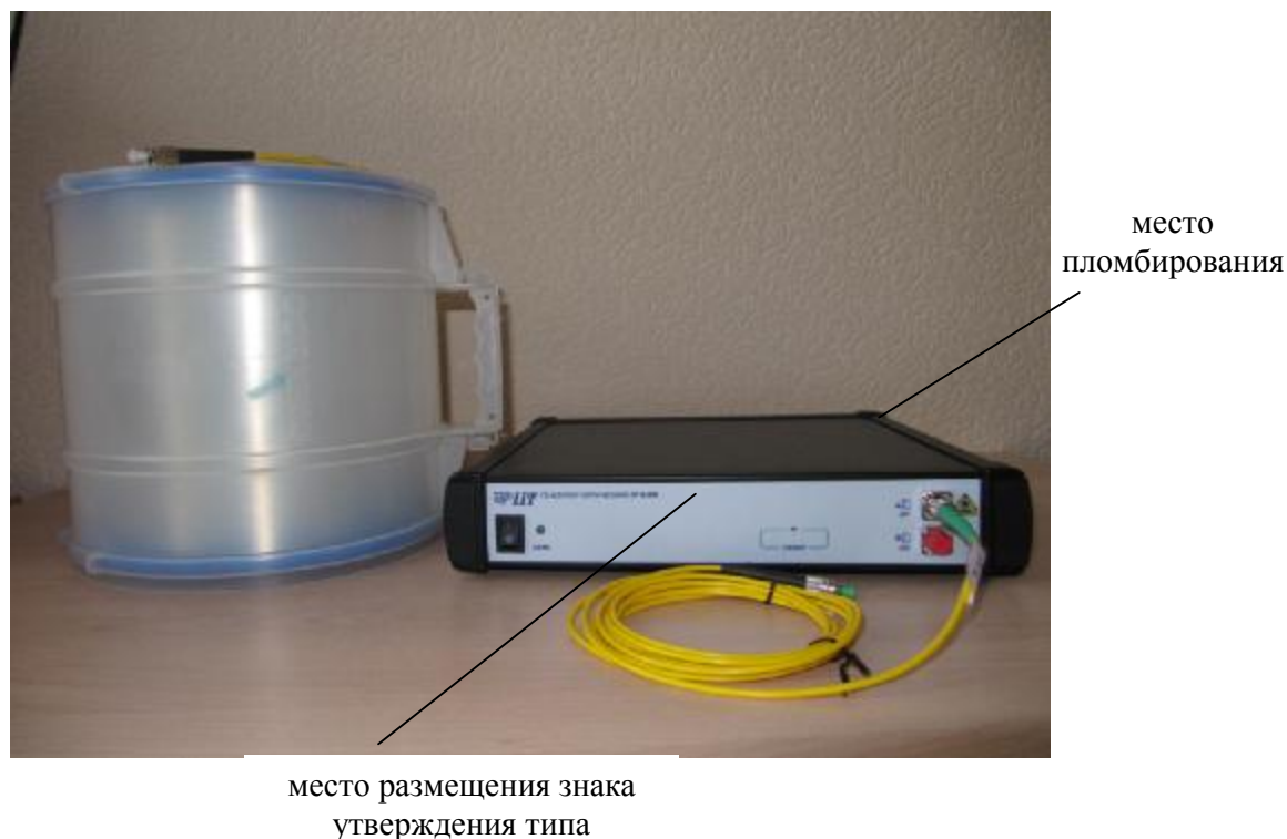
Рисунок 1 – Внешний вид рабочего эталона единиц длины и ослабления в световоде с указанием мест пломбирования и размещения знака утверждения типа
