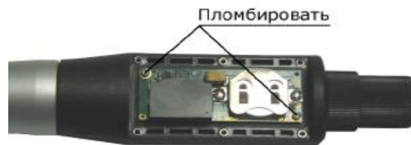
Рисунок 3 — Схема пломбировки нутромера электронного от несанкционированного доступа
