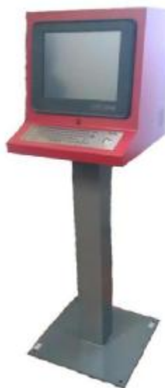
Рисунок 1 – Фотография общего систем измерения и контроля процесса запрессовки колесных пар вагонов
