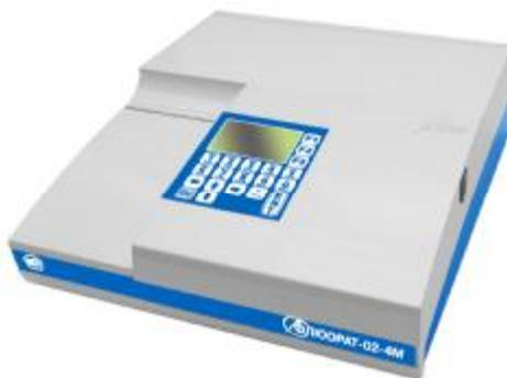
Рис.1 - Внешний вид анализаторов жидкости люминесцентно-фотометрических «Флюорат-02»
