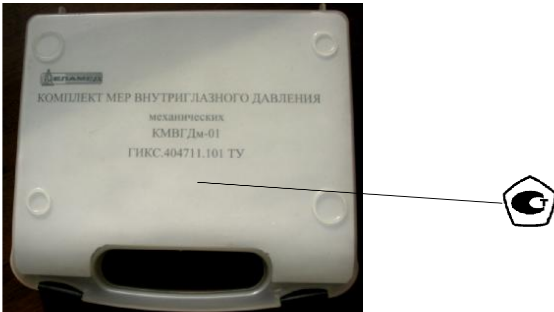
Рисунок 1 – Внешний вид Комплектов мер внутриглазного давления КМВГДм-01 и схема их маркировки.
