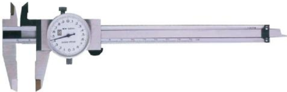
Рисунок 2 - Общий вид штангенциркулей типа ШЦК-I.
