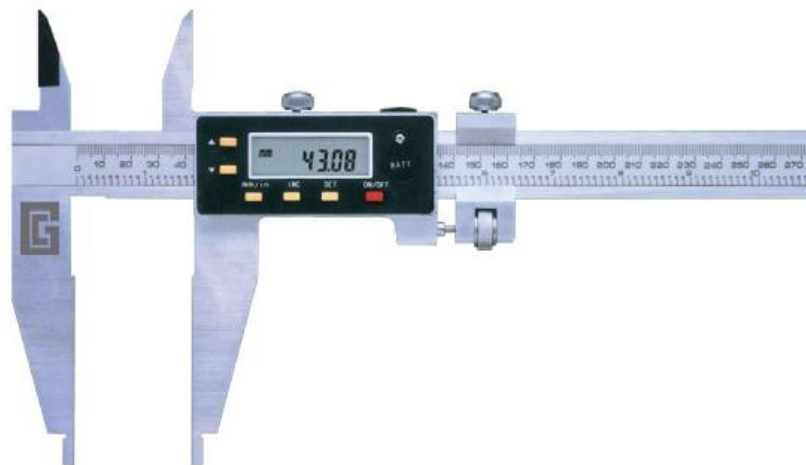
Рисунок 9 - Общий вид штангенциркулей типа ШЦЦ-V.
