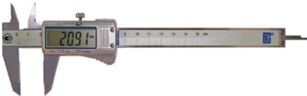
Рисунок 3 - Общий вид штангенциркулей типа ШЦЦ-I.
