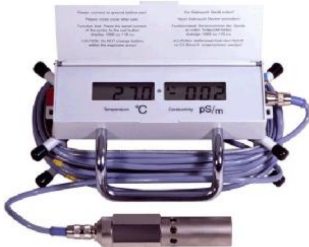
Рис.1 Внешний вид измерителя проводимости легких нефтепродуктов MLA 900
