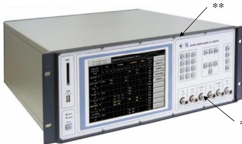
Рисунок 1 – Внешний вид блока имитации имитатора и места пломбировки от несанкционированного доступа и нанесения знака об утверждении типа
