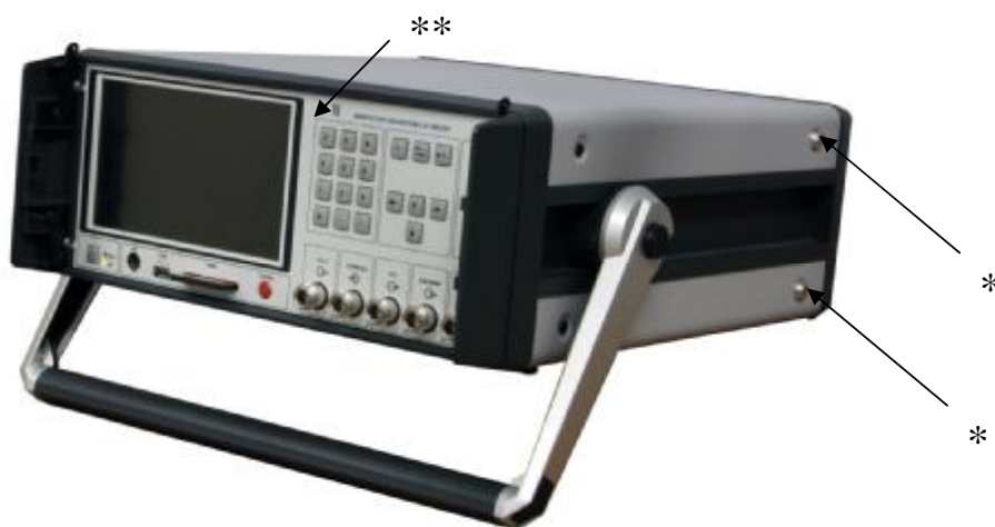
Рисунок 1 – Внешний вид блока имитации имитатора и места пломбировки от несанкционированного доступа и нанесения знака об утверждении типа
