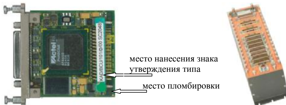
Рисунок 1 - Внешний вид модуля KAD/BCU/101/D установленного в блок базовый КАМ/CHS/13U
