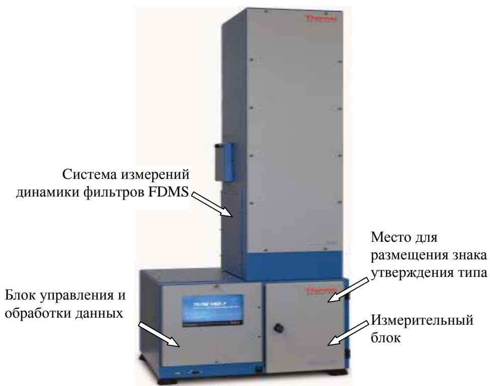
Рисунок 2 – Внешний вид анализаторов пыли модификаций TEOM 1405-F и TEOM 1405-DF и обозначение места для размещения знака утверждения типа
