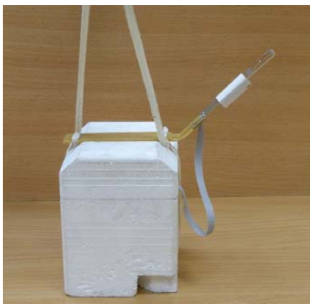
Рисунок 1 - Фотография общего вида радиозонда
