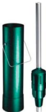
рис. 1 Вид ареометра с футляром
