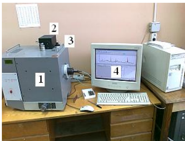
Рисунок 1 – Внешний вид комплекса атомно-эмиссионного для анализа водорода в титановых сплавах с регистратором спектра МОРС-1 (1 – генератор конденсированной искры в штативе УШТ-4, 2 – мини-спектрометр, 3- регистратор спектра оптический многоканальный МОРС-1, 4- компьютер).
