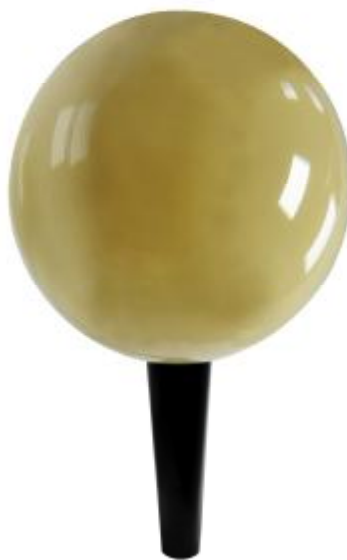
Рис. 3 Общий вид мер для поверки систем томографических General Electric с керамической сферой
