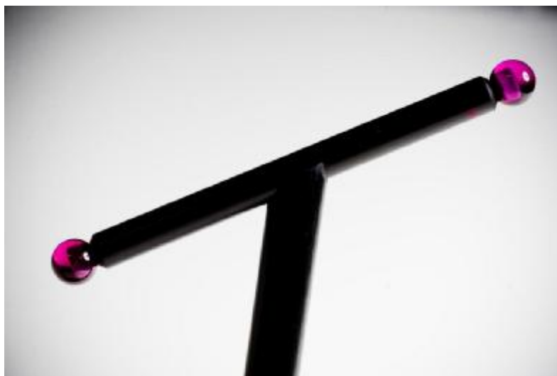
Рис. 1 - Общий вид мер для поверки систем томографических General Electric с 2 рубиновыми сферами
