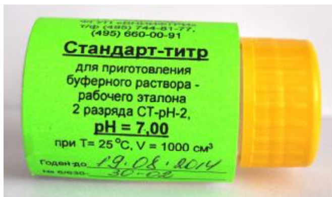
Рисунок 1 – Стандарт-титр со значением pH=7,00 для приготовления буферного раствора – рабочего эталона pH 2-го разряда СТ- pH -2( pH=7,00 )
