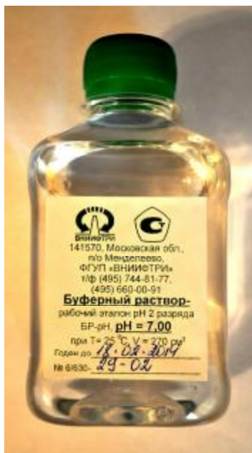
Рисунок 1 – Буферный раствор со значением pH=7,00 – рабочий эталон pH 2-го разряда БР- pH(pH=7,00)
