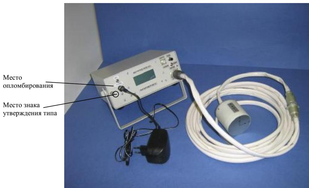
Рисунок 1. Внешний вид магнитометра МТ-5
