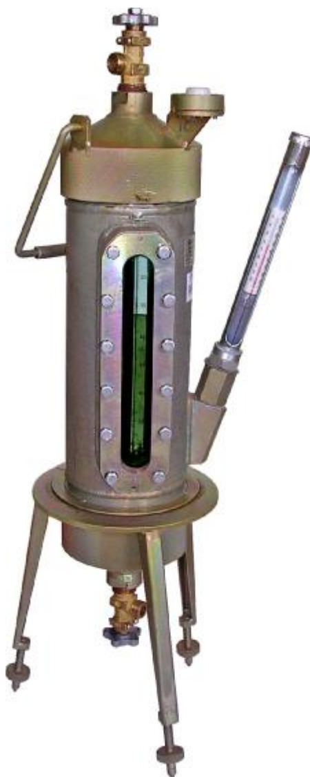
Рисунок 2 – Внешний вид измерителя плотности
