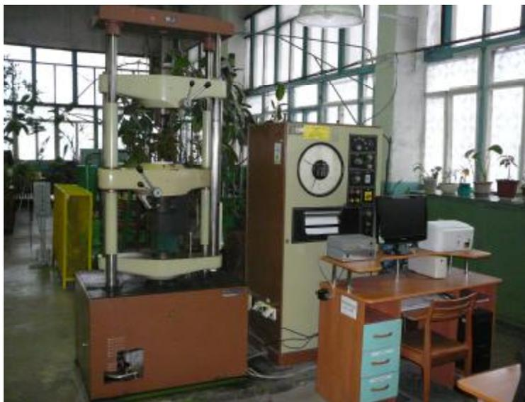
Рис. 1. Общий вид машины EU-40К
