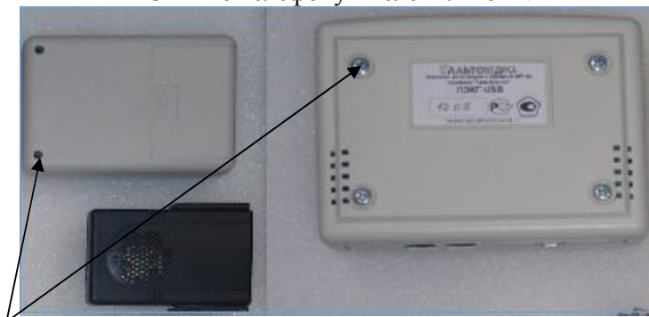
Рисунок 2 – Схема пломбировки от несанкционированного доступа
