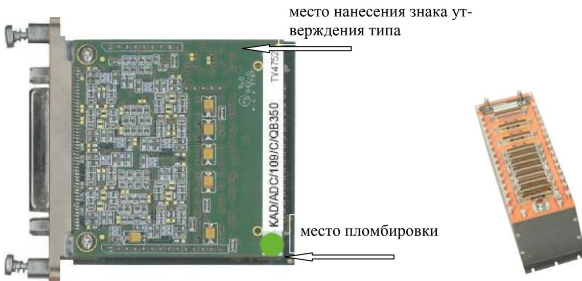
Рисунок 2 - Внешний вид модуля KAD/ADC/109/C/QB350, модуля KAD/ADC/109/C/QB350 и KAD/ADC/109/C/QB120, установленного в блок базовый KAM/CHS/13U
