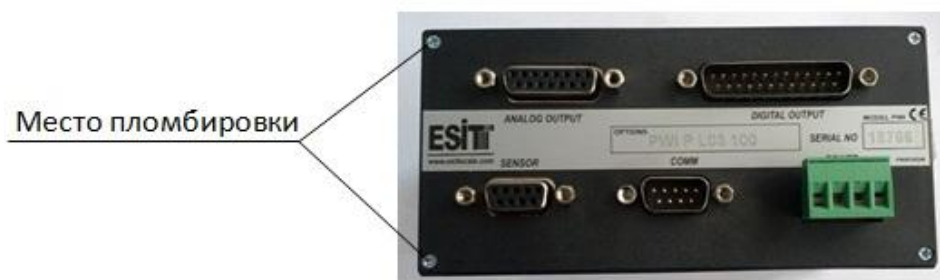
Рисунок 12 — Место пломбировки индикатора PWI-P (пломбировка мастикой в пломбирочной чашке или разрушаемой наклейкой)
