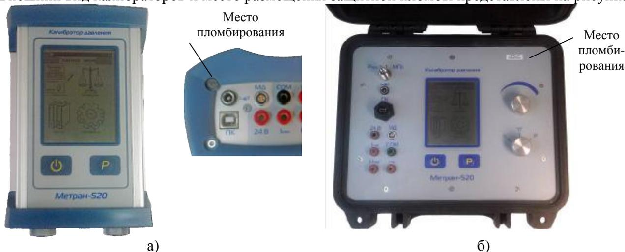
Рисунок 1 – Калибраторы давления Метран-520:
