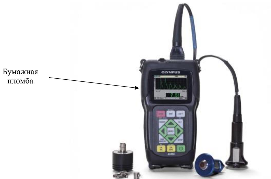
Рисунок 1 – Внешний вид толщиномеров
