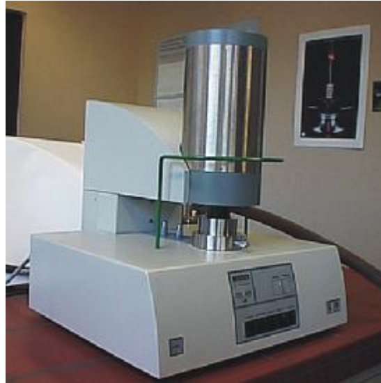
Рис.4. Внешний вид калориметра дифференциального сканирующего, модификации DSC 404 C.
