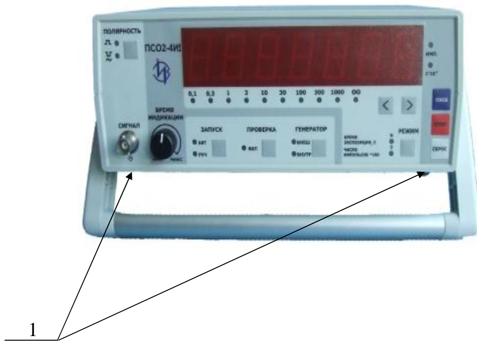
1 – Пломбы с оттиском клейма поверителя Рисунок 1 – Общий вид ПСО2-4И1
