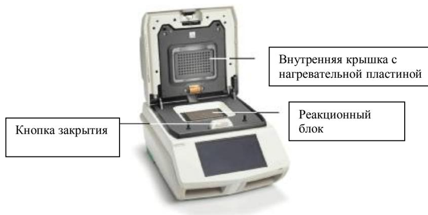
Рис. 2. Внутренний вид модулей
