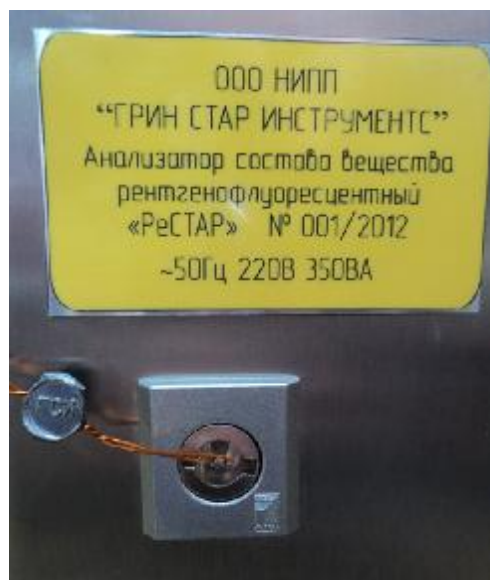
Рисунок 2. Схема пломбировки от несанкционированного доступа и место нанесения знака утверждения типа
