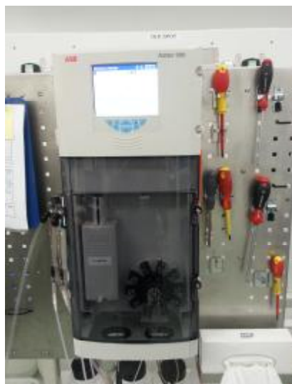
Рис. 2. Общий вид анализаторов воды Aztec 600 с колориметрическим датчиком.
