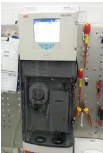
Рис. 1. Общий вид анализаторов воды Aztec 600 с ионоселективным датчиком.
