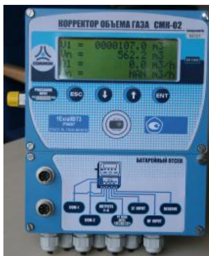
Фото 1. Общий вид корректора объема газа СМК-02.
