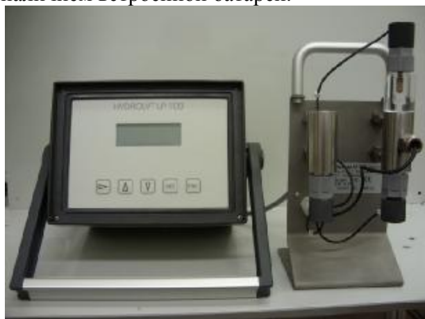
Рис.1 Анализатора растворенного водорода HYDROLYT LP100 (портативный). Вид спереди.
