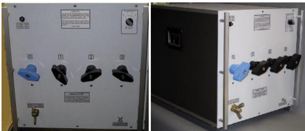
Рис. 1в Внешний вид эквивалентов сети NNLK 8129 (слева) NNLK 8130 (справа)
