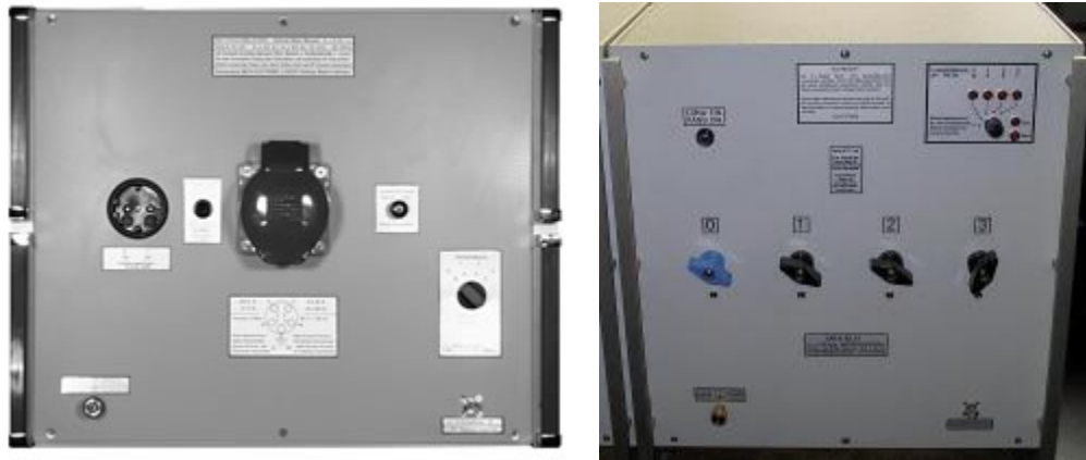
Рис. 1б Внешний вид эквивалентов сети NSLK 8128 (слева) NNLK 8121 (справа)
