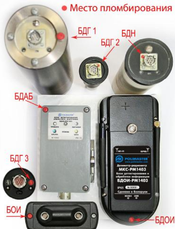
Рисунок 2 – Места пломбирования БДОИ, БОИ и внешних блоков детектирования
