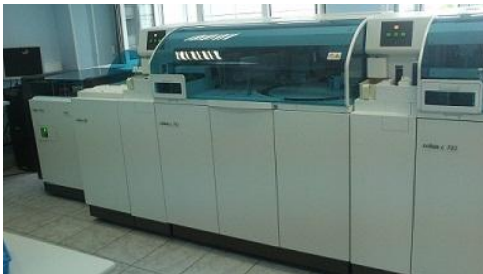
Рис.1 - Платформа модульная для биохимического и иммунохимического анализа Cobas 8000 (входят модули с701, с702, ISE).
