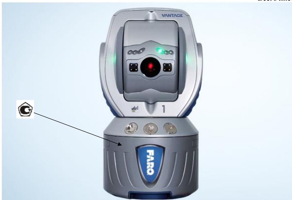
Рисунок 1 – Общий вид машины координатно-измерительной мобильной FARO Laser Tracker VANTAGE и место нанесения знака утверждения типа
