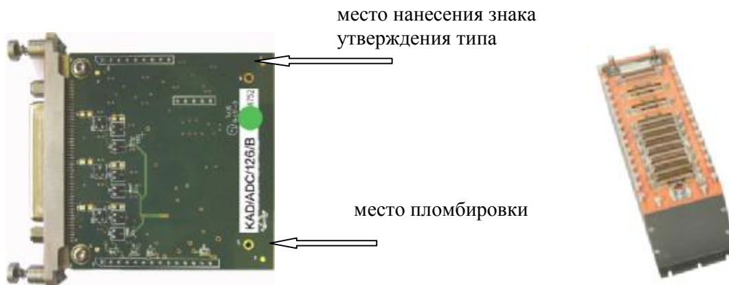
Рисунок 1 - Внешний вид модуля KAD/ADC/126 и модуля KAD/ADC/126 установленного в блок базовый KAM/CHS/13U
