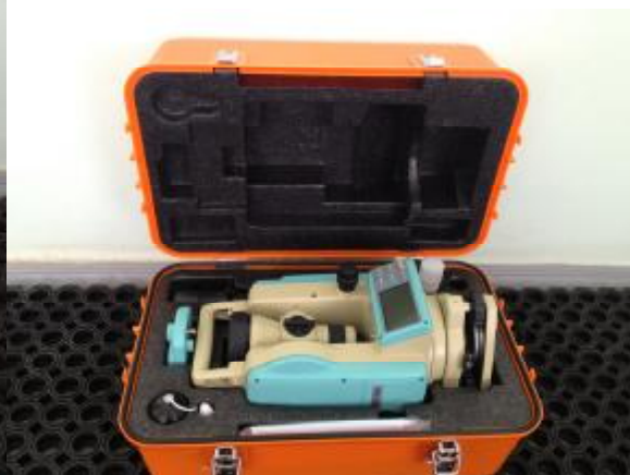
Рисунок 4 - Внешний вид размещения теодолита в футляре
